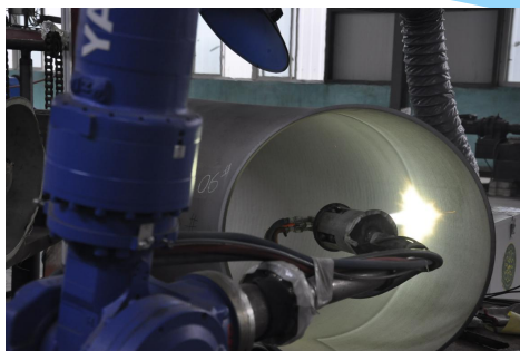
软线丝材经专用喷枪预制到基体表面
